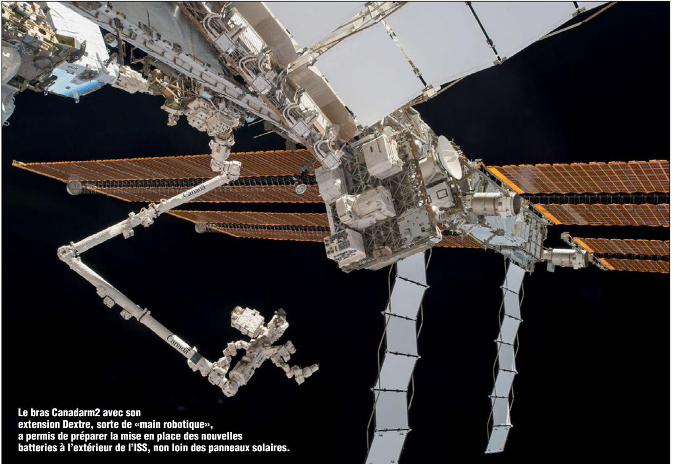
**Le bras Canadarm2 avec son extension Dextre, sorte de «main robotique», a permis de préparer la mise en place des nouvelles batteries à l'extérieur de l'ISS, non loin des panneaux solaires.**
